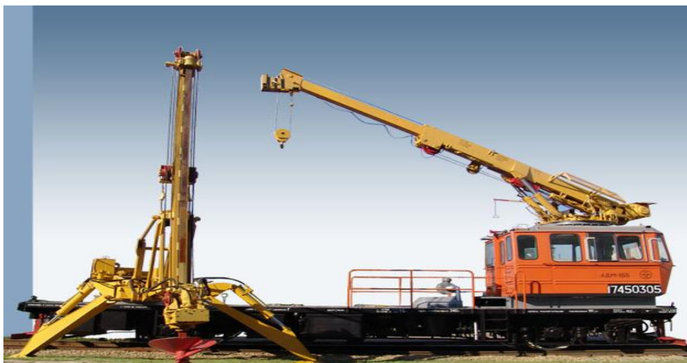
Рис. 2. Автомотриса с буровой установкой в рабочем положении
