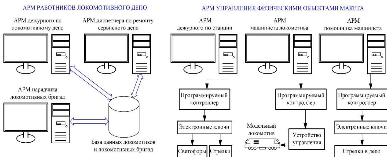
Рис. 2. Функциональная схема тренажерного комплекса
