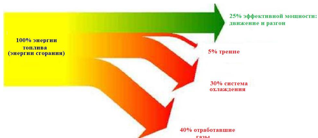
Рис. 3. Диаграмма теплового баланса современных ДВС [3]
