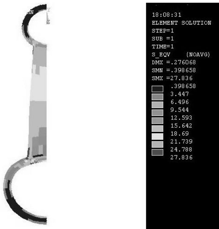
Рис.4. Эквивалентные напряжения после оптимизации
