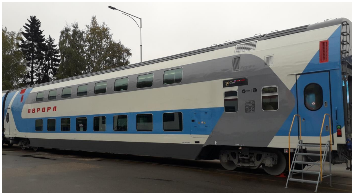
Рис. 1. Вагон пассажирский двухэтажный с местами для сидения модели 61-4492
