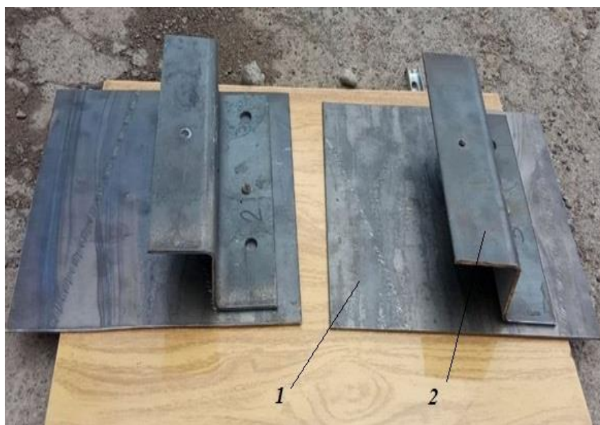
Рис. 4. Каркас опытных образцов: 1 – лист обшивки; 2 – Z-образный профиль
