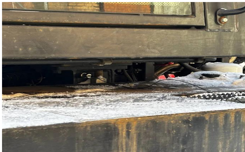
Рис. 3. Измерение вибраций на опоре кабины трактора
