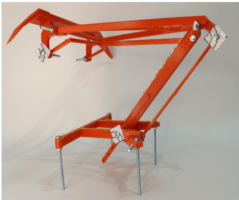
Рис. 4. Модель токоприемника, напечатанная на 3D принтере.
