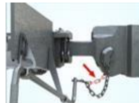
Несоответствие длины цепи расцепного привода
