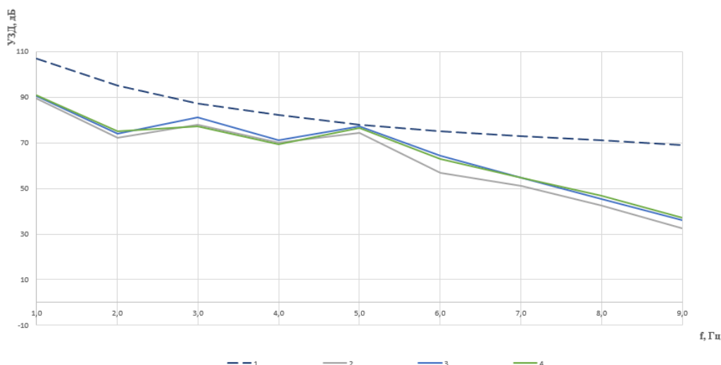
Рис.6. Исследуемые спектры шума в кабине комбайна с установленными технологическими агрегатами:
