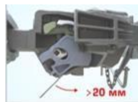
Неисправность от саморасцепа
