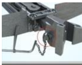
Нарушение крепления предохранителя валика подъёмника
