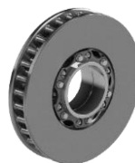
Рис. 1. Тормозные диски с узлами охлаждения: оребрение нерабочих поверхностей полудисков (а); вентиляционные каналы, расположенные между полудисками (б)
