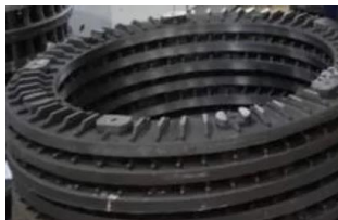
Рис. 1. Тормозные диски с узлами охлаждения: оребрение нерабочих поверхностей полудисков (а); вентиляционные каналы, расположенные между полудисками (б)
