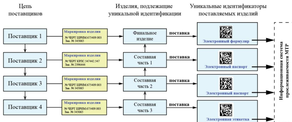
Рис. 1. Схема идентификации и маркирования изделий в процессе производства
