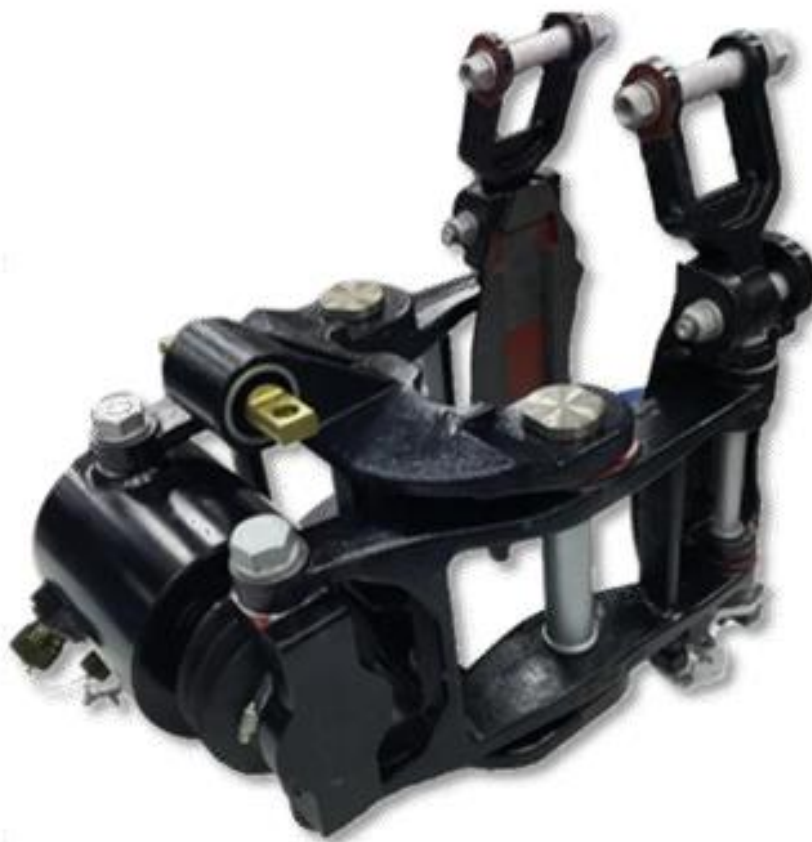
Рис. 1. Электромеханический тормоз для подвижного состава
