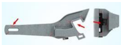
Трещины на корпусе автосцепки
