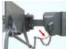
Несоответствие длины цепи расцепного привода
