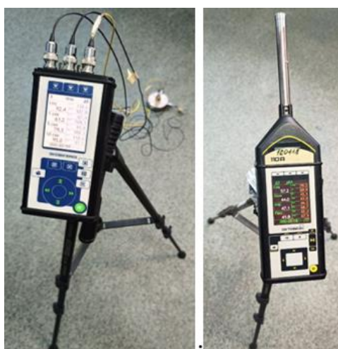
Рис. 3. Шумомеры-виброметры, анализаторы спектра Экофизика-110А и Октава-110А
