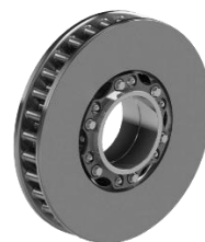
Рис. 1. Тормозные диски с узлами охлаждения: оребрение нерабочих поверхностей полудисков (а); вентиляционные каналы, расположенные между полудисками (б)
