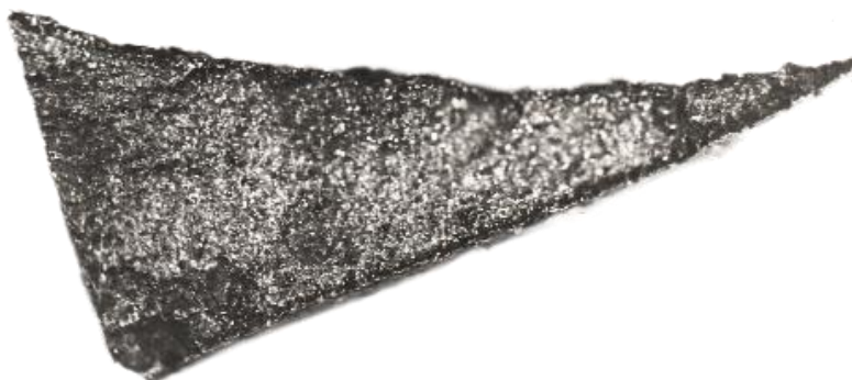
Рис. 4. Излом расколовшейся части фрагмента пружины
