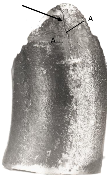
Рис. 2. Общий вид фрагмента излома пружины
