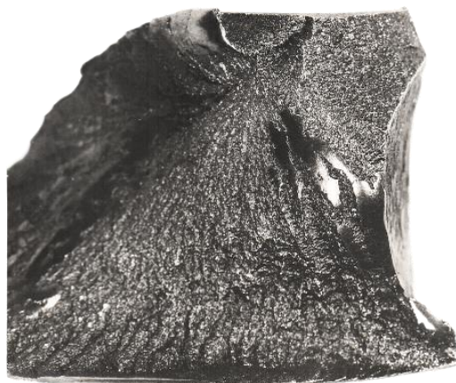
Рис. 3. Вид с внешней стороны излома
