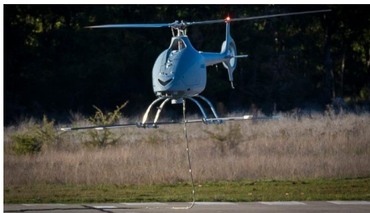
Рис. 4. Беспилотный вертолет компании Airbus VSR700
