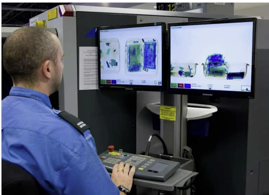
Рис. 2. Рентгентелевизионная досмотровая установка
